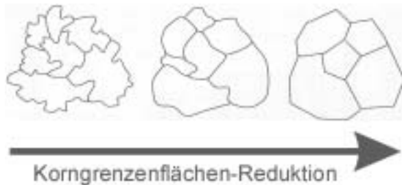
Abb. 2.6: Schematische Darstellung des Prozesses der Korngrenzenflächenreduktion. Unter Glättung irregulärer Korngrenzen und Kornwachstum bildet sich ein polygonales Korngefüge heraus (aus Passchier & Trouw 1996).
