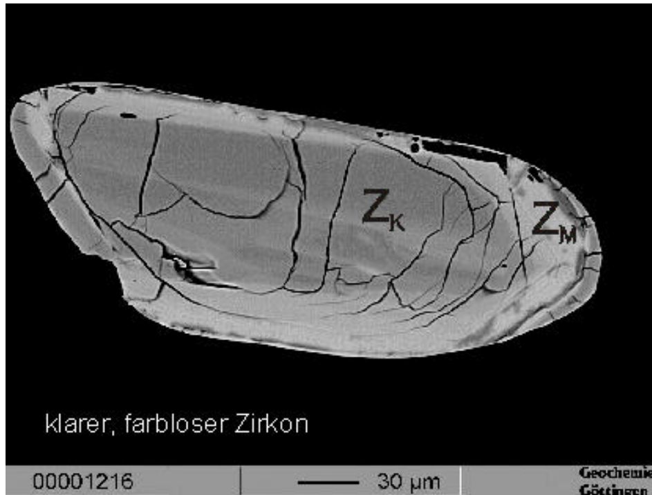
Abb. 5-3: BSE-Bild eines typischen klaren Zirkons (Fraktion 100-125 µm) des Gunnarstan Granites.
