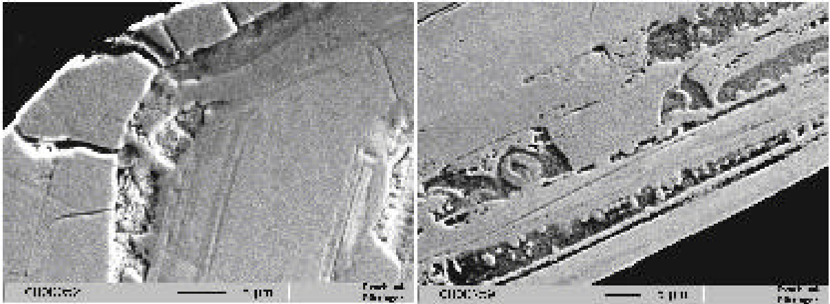
Abb. 6-4: SE-Bilder von eingebetteten und polierten Zirkonen (Fraktion 100-125 \mu\text{m} ) des Gunnarstan Granites. Es sind deutliche Morphologien im Bereich der Alterationsstrukturen durch die Politur der Proben zu erkennen.
