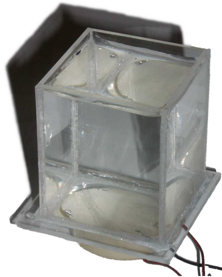
Abbildung B.1: Quaderförmige Küvette aus PMMA; Foto aus APPEL [83].
