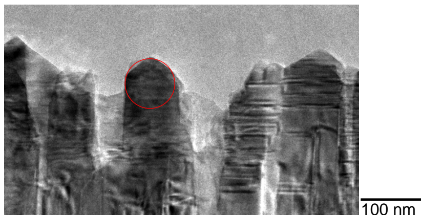
Abbildung 7.9: Übersicht des beleuchteten Bereichs für die ALCHEMI-Untersuchung (Messung B).
