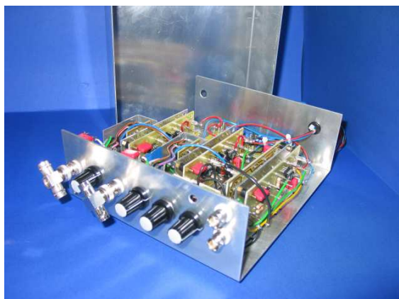
Abb. 5.7: NFF für das Laserexperiment. Das gezeigte Gerät enthält bereits zwei von außen mit einer Steuerspannung modulierbare Wien-Brücken. Die Güte der Filter wird durch den internen Aufbau festgelegt und kann von außen im Gegensatz zur Filter-Resonanzfrequenz nicht geändert werden. Die Filter-Ausgangssignale werden anschließend mit der Endstufe aus Abb. 5.5b verstärkt und modulieren via Bias-T den Pumpstrom des Lasers.
