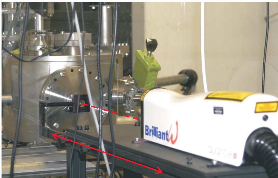
Abbildung 4.11: Aufbau des Lasers und der Fokussierlinse an der PLD-Anlage. Eingezeichnet sind der Strahlengang des Lasers (Strichlinie) und die verschiebbare Linsenhalterung (Pfeile).
