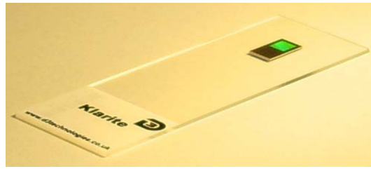
Abbildung 7.12: Foto eines Klarite ® -Substrats, das auf einem Objektträger befestigt ist. Der grünlich wirkende Bereich markiert die nanostrukturierte Oberfläche, die von einer unstrukturierten Goldoberfläche umgeben ist.
