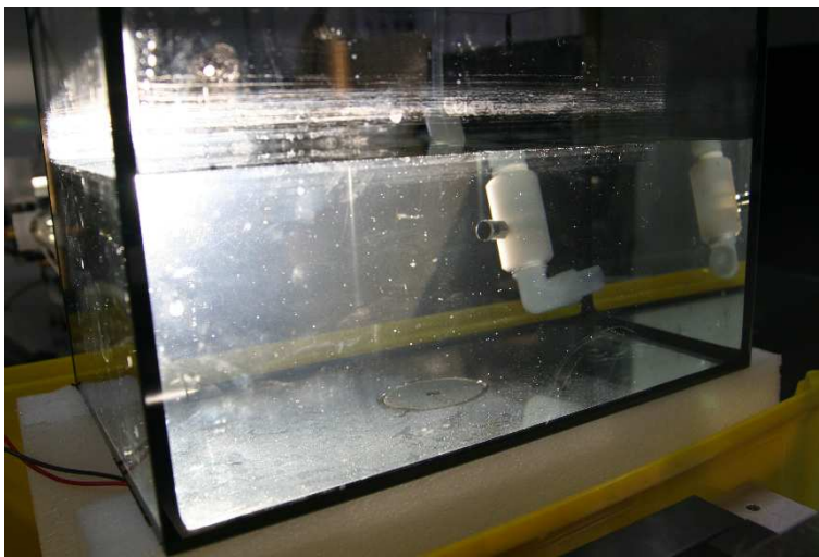
Abbildung C.2.: Foto der mit Wasser gefüllten Küvette. Der Wandler ist in der Mitte des Beckens am Boden zu sehen.
