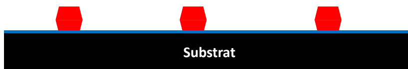
Abbildung 6.6.: Skizze des Ankeimprozesses der ersten Monolagen. Es bildet sich ein sehr dünner benetzender Perowskitfilm (rot), in den kleine Spinellkeime (blau) eingebettet sind.
