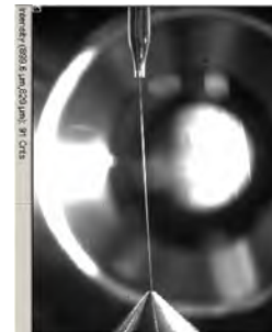
(f) Argonstrahl verläuft schräg durch Kammer.
