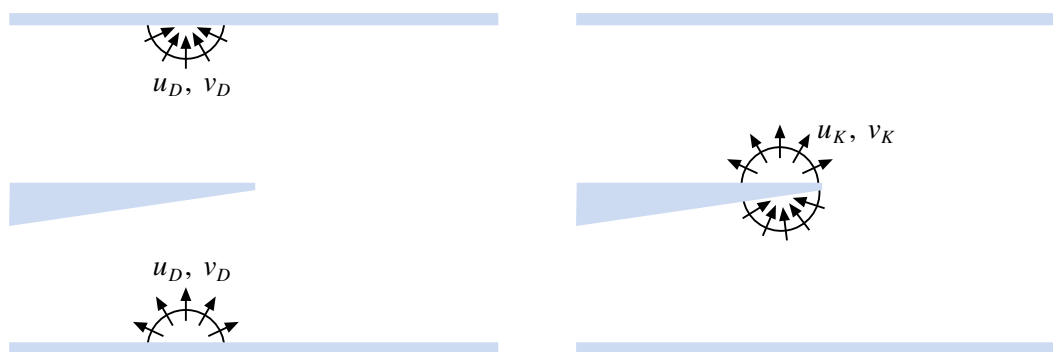
Abb. A.3: Das Modell der Anregungsvorrichtungen bei der numerischen Rechnung durch eine Verteilung von Quellen und Senken. Die linke Darstellung zeigt die Druckgradient-Anregung, die rechte Seite ist die Schwingkanten-Anregung.
