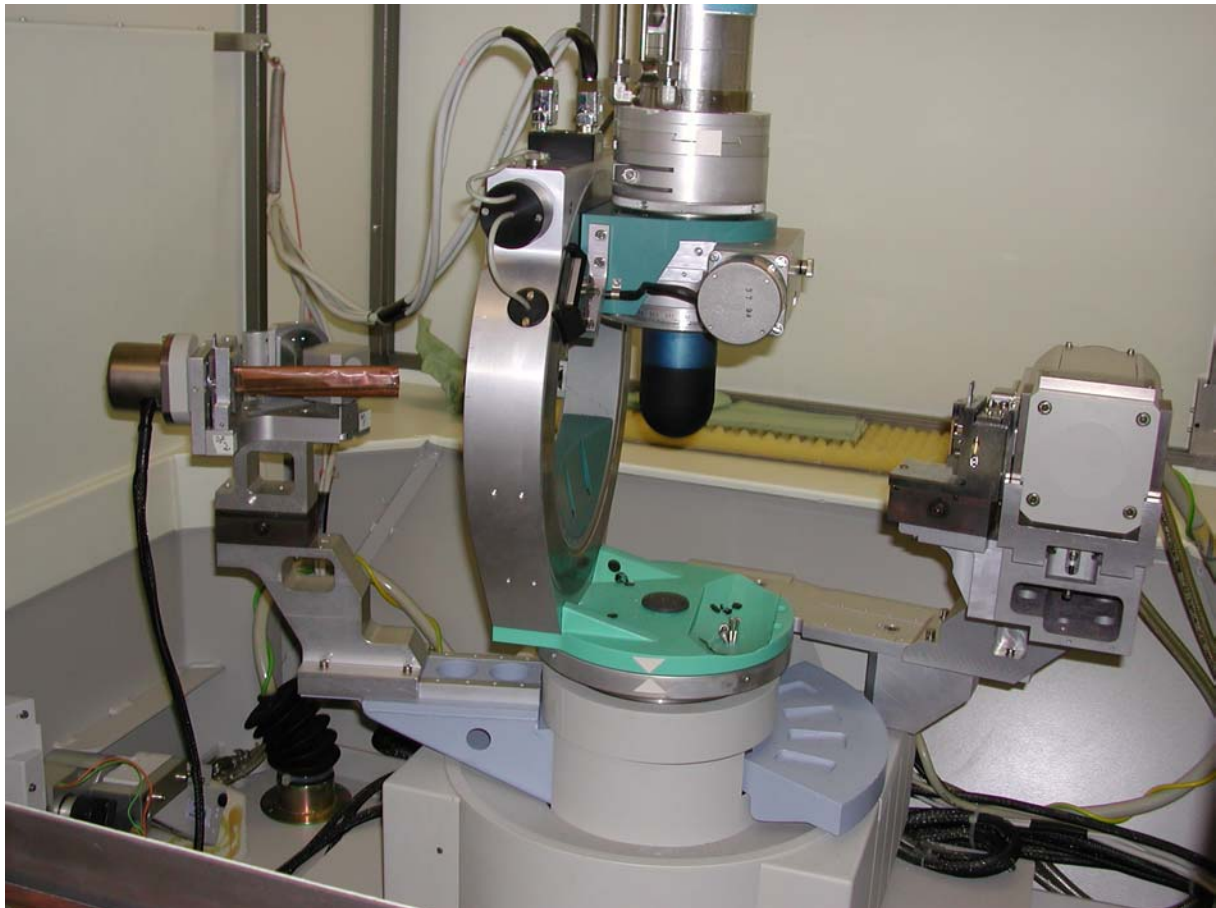
Abbildung 2.3: Philips-MRD Röntgendiffraktometer mit APD-Cryostat. Bild links: Detektorkreis mit Kupferpipe, Bildmitte: Huber-Eulerwiege mit aufgebautem APD-Helium-Kryostaten und aufgeschraubtem Vakuumdom, Bild rechts : Röntgenröhre.
