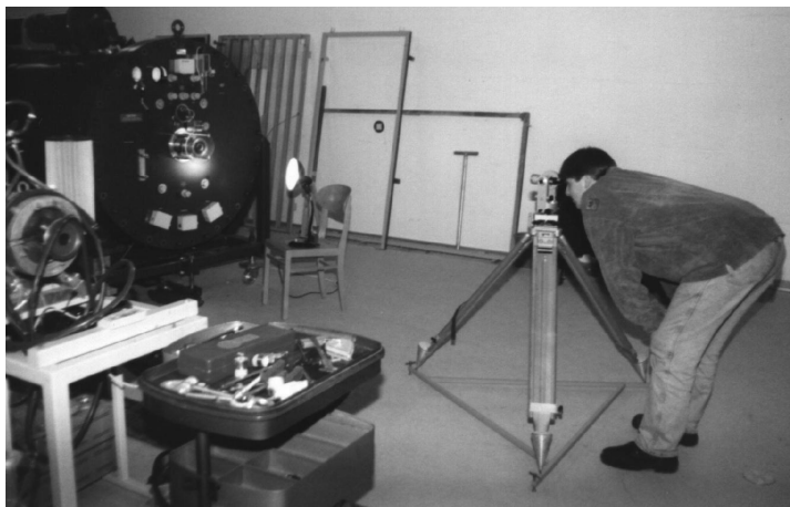
Abbildung 82: Alle Teile der Ionenoptik wurden mit Hilfe von Theodoliten, einem Justierlaser und Wandmarken ausgerichtet.
