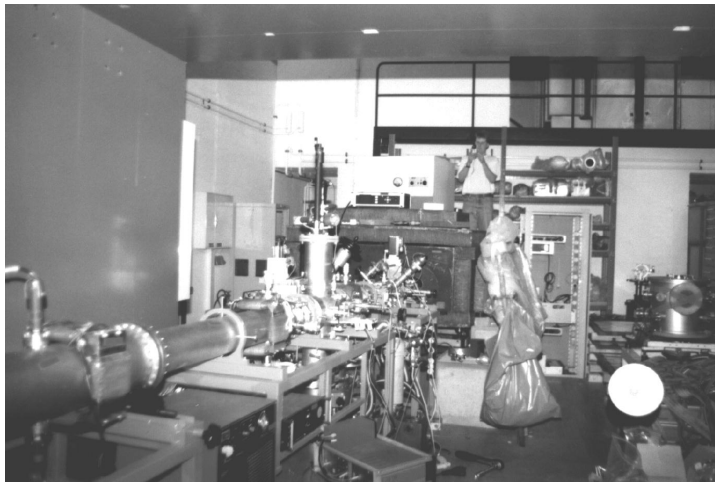
Abbildung 84: Alle Teile des Nullgrad-Strahlrohrs und die Eisenabschirmung der Low-Level Apparatur sind fertig aufgebaut und vakuumgetestet. In diesem Bild ist die Eisenabschirmung noch nicht von den Szintillator-Platten zur Antikoinzidenz-Messung umgeben.
