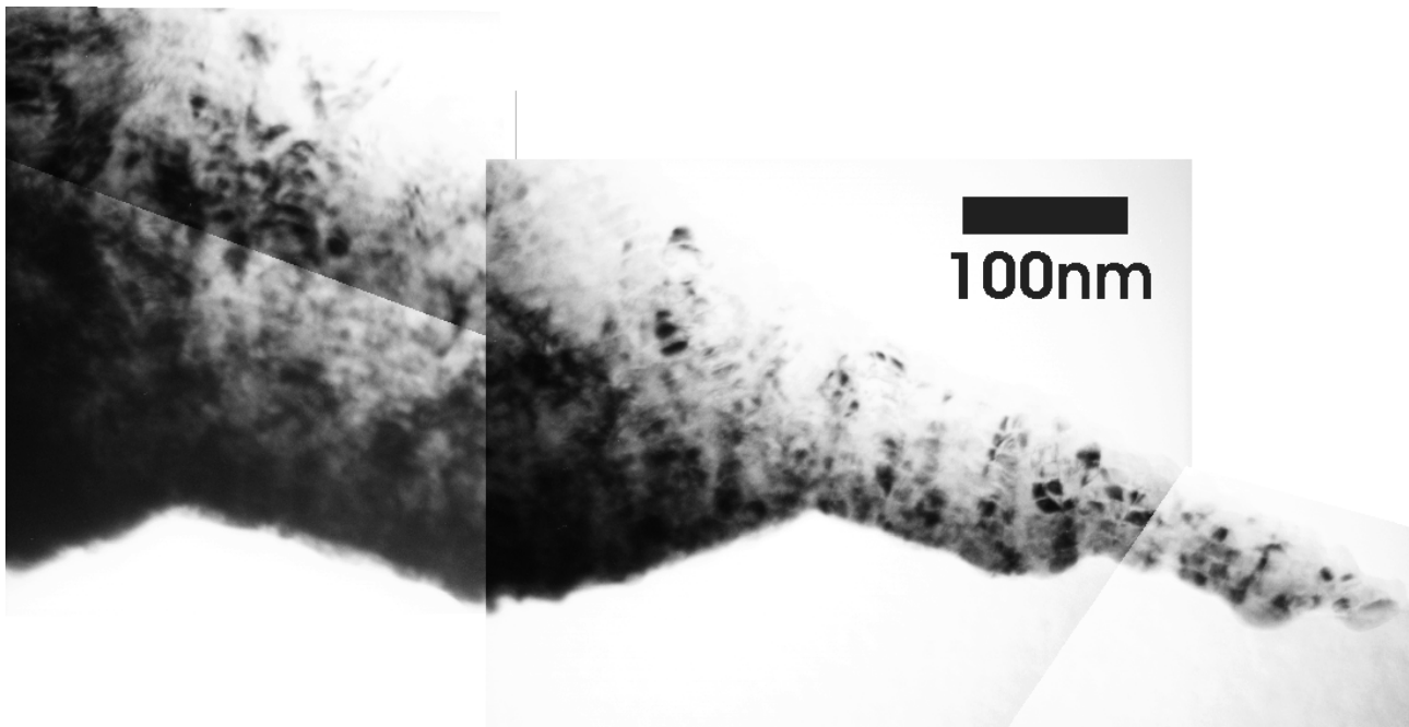
Abbildung 108: Querschnittspräparation TEM: Hellfeld-Abbildung eines 50x(2nm Eisen/10nm Silber)-Schichtsystems auf facettiertem Al_2O_3 .
