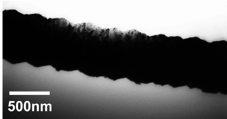
Abbildung 107: TEM-Querschnitt eine 50x(2nm Fe/10nm Ag) Schichtpakets auf facettiertem Al_2O_3 .
