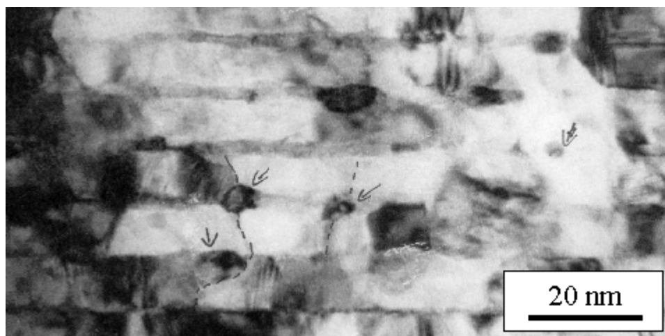
Abbildung 4.7: Anfangsstadium der Desintegration einer Niob/Kupfer-Vielfachschicht (2 nm/10 nm). Viele der ersten Partikel bilden sich in oder an Korngrenzen der Kupferschicht.
