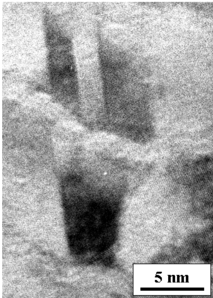
Abbildung 6.3: Zwillingsgrenzen innerhalb der Silberlagen einer Eisen/Silber-Vielfachschicht (2 nm/10 nm). Sie reduzieren die Spannungsenergie im System.
