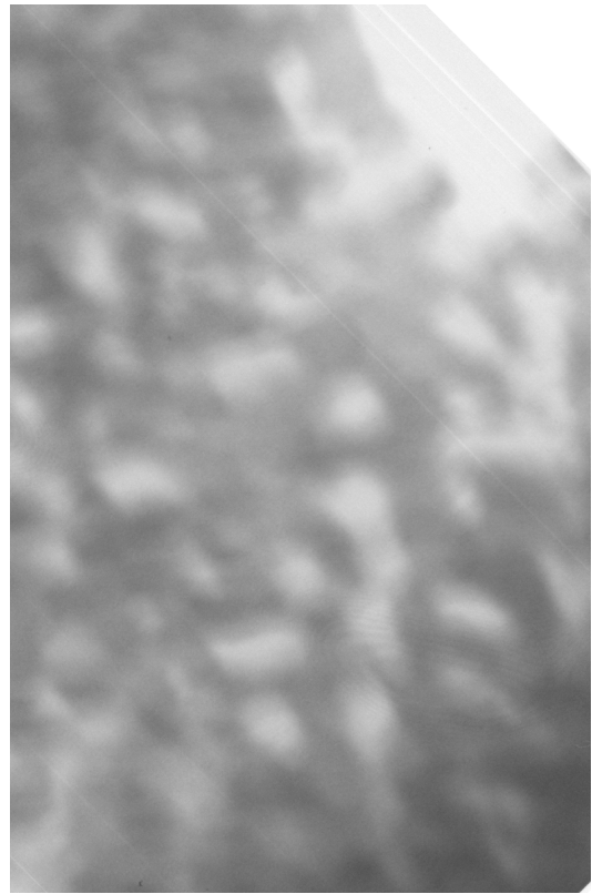
Abbildung 2.5: Z-Kontrast-Bild einer ausgelagerten Eisen/Gold-Vielfachschicht. Hell ist das schwach streuende Eisen, dunkel das Gold zu sehen.
