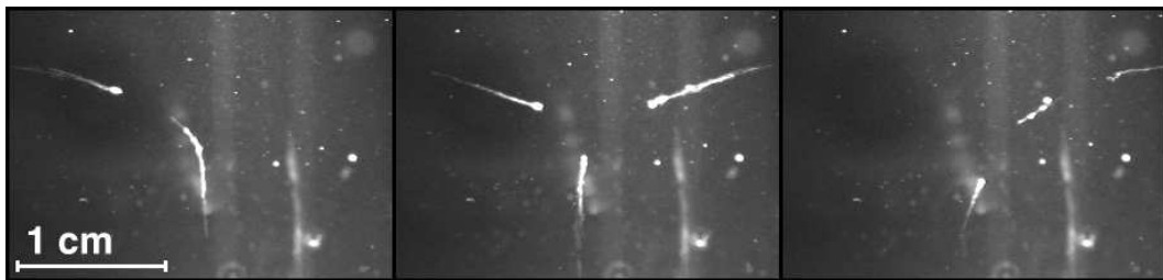
Abbildung 7.7: Zweidimensionale Streamerkonfiguration, die Blasenquellen befinden sich an den Seitenwänden und am Resonatorboden, Bildabstand 0.5 - 1 s, Belichtungszeit 16 ms.
