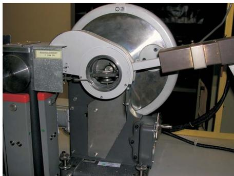
Abbildung 4.6: Pulverdiffraktometer PW1710 der Fa. Philips
