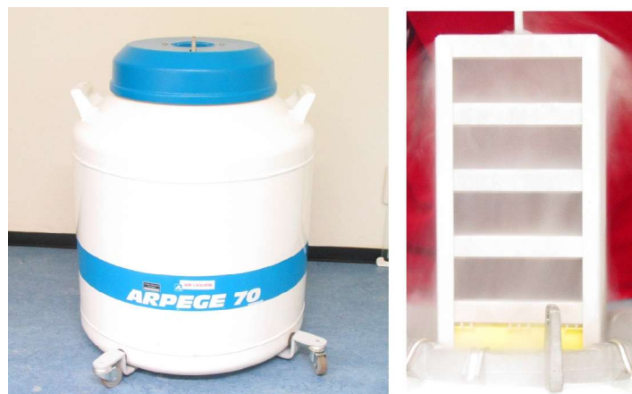
Abbildung 13: links: Cryo-Tank, rechts: Halterung für die Cryo-Röhrchen
