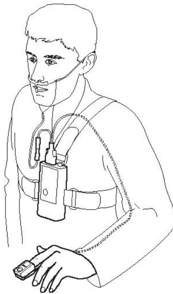
Abb. 2: Patient mit Somnocheck Effort (inklusive Atemfluss-Schnarch-Sensor, Thorax- und Abdomen-Sensor, sowie Pulsoxymeter).
