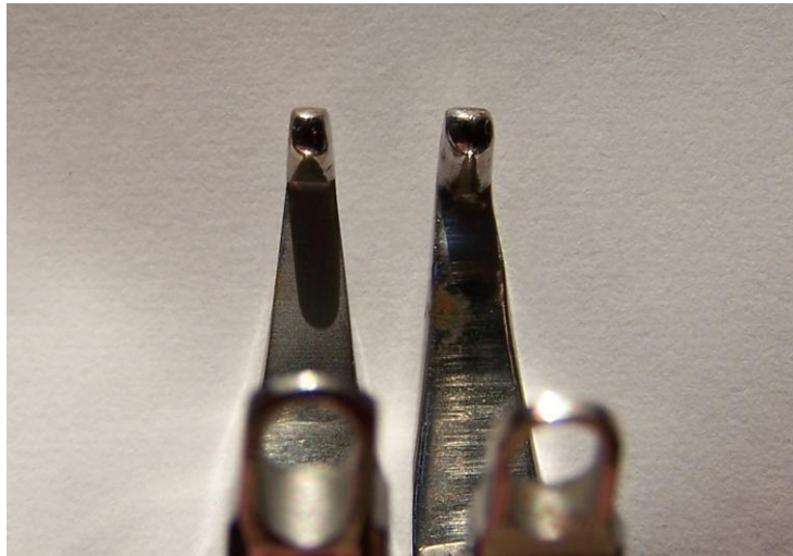
Abbildung 12 Bumpzange mit dünner (links) und dicker Wirkstelle (rechts)
