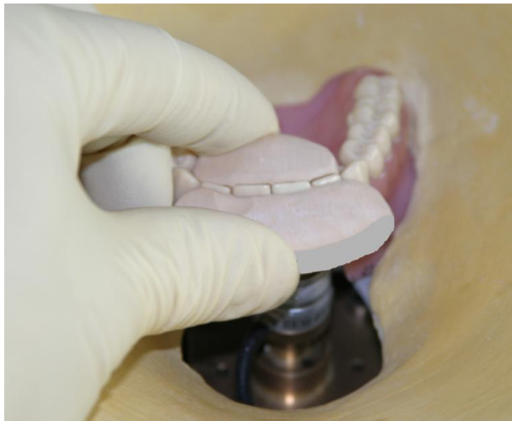
Abbildung 4 Gipsschlüssel zur Positionierung des Messzahnes
