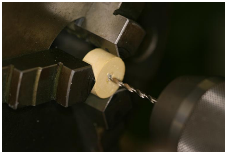
Abbildung 7 Anlegen der Normbohrung an der Unterseite des im Gips fixierten Messzahnes (aus: Engelke 2010, S. 12)
