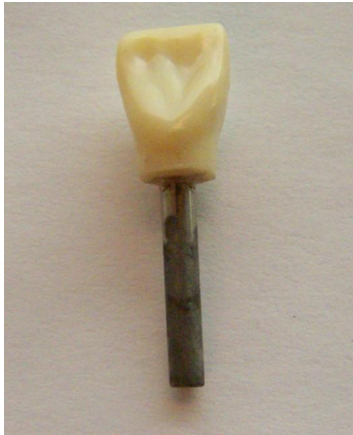
Abbildung 8 Messzahn, bestehend aus gekürztem Frascozahn 11 und dem Schaft des gekürzten Spiralbohrers
