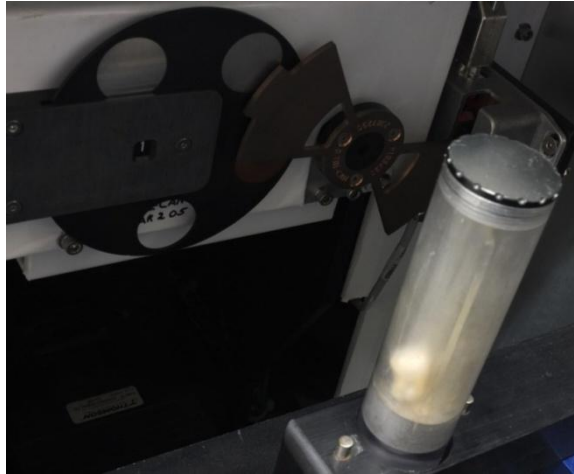
Abb. 4.4: Kammer mit Objektträger und Filtrerrad
