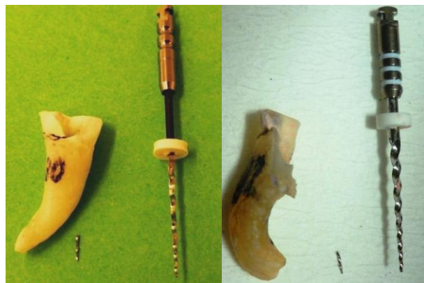
Abb. 5.14: Instrumentenfraktur D2 (D-RaCe) links und D3 (ProTaper Retreatment) rechts
