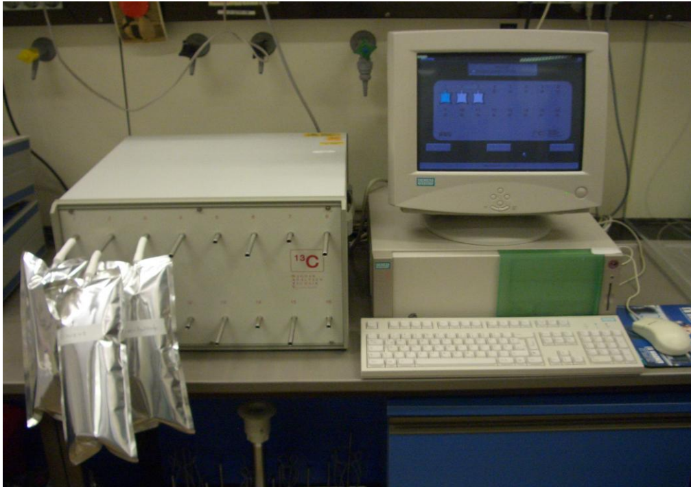
Abb. 7: Links im Bild das Massenspektrometer mit Spezialbeuteln zur Bestimmung des ^{13}\text{C}\text{O}_2 , rechts das Computerprogramm zur Auswertung (Abteilung Gastroenterologie und Endokrinologie, Universitätsmedizin Göttingen)
