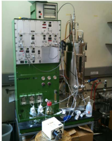
Abb. 4-7: A , 15 L-Bioreaktor Biostat E Typ ES der Firma B. Braun. B , P. pastoris Cx43-GFP Zellen vor der Induktion ( rechts ) und nach der Induktion ( links ) der Proteinexpression mit Methanol.
