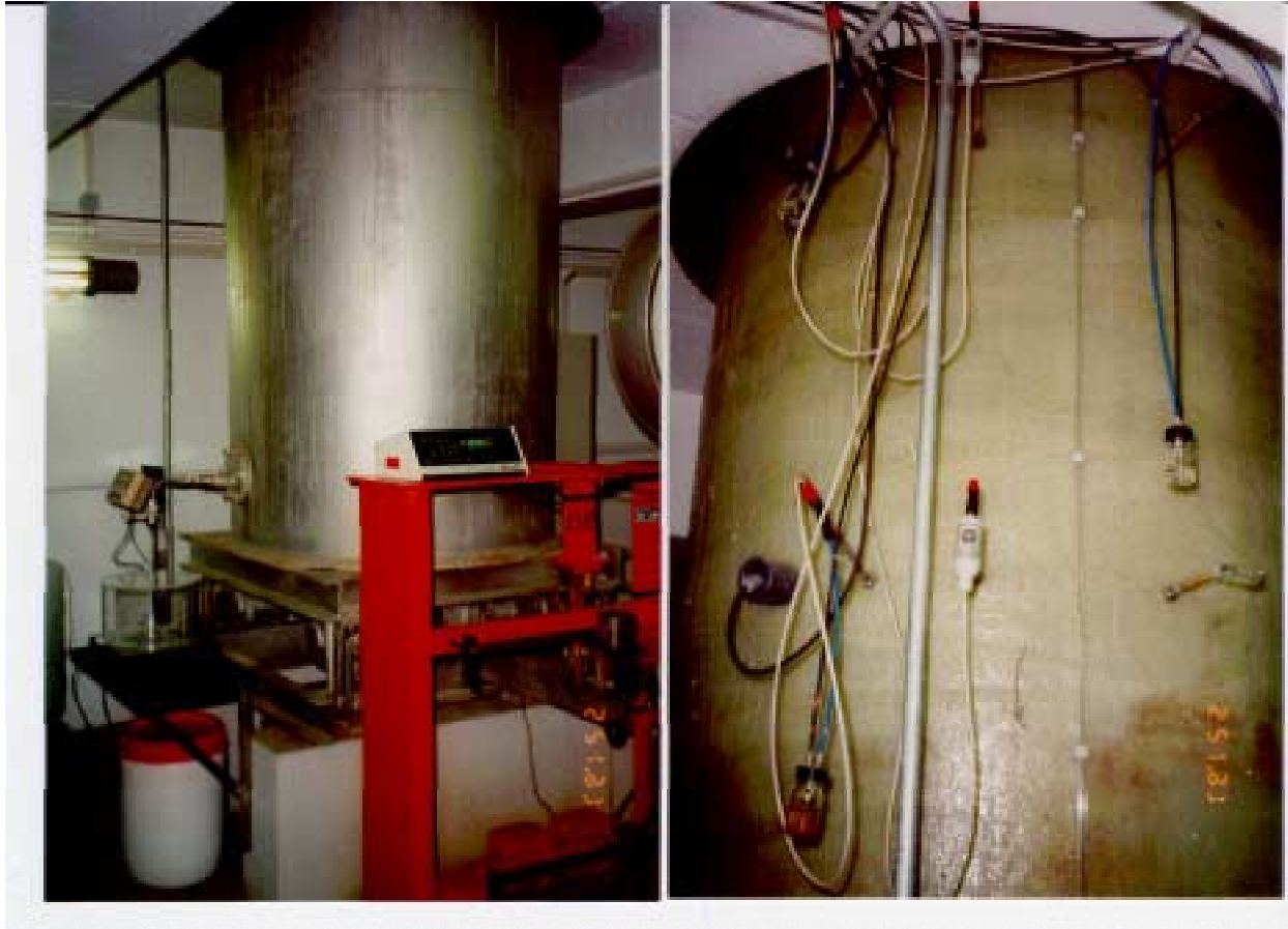
Abb. 3: Einzellysimeter mit Wägeeinrichtung, Sickerwasserauslauf, Saugkerzen, Tensiometern, TDR-Sonden und Sonden zur Bodenluftentnahme
