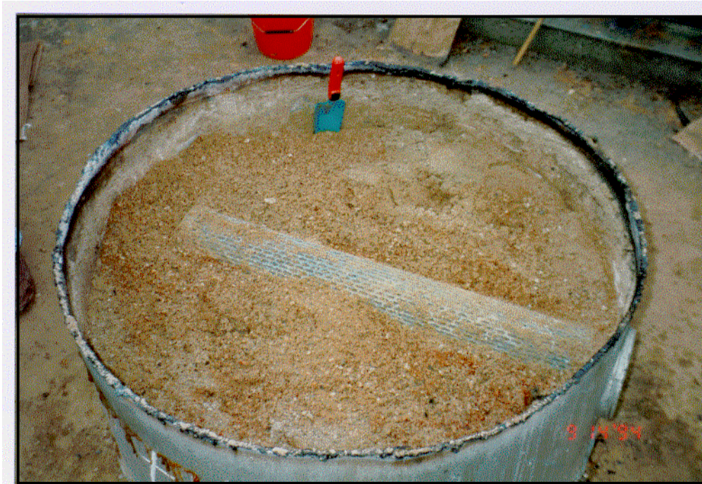
Abb. 4: Filterrohr für den Sickerwasserablauf am Lysimeterboden
