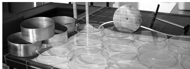
Abbildung 4 Aufgetaute Proben Abbildung 5 Ringe zum Befüllen, Stempel und Petrischalen
