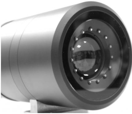
Abbildung 2 Messkopf mit konzentrisch angeordneten Lichtleitern
