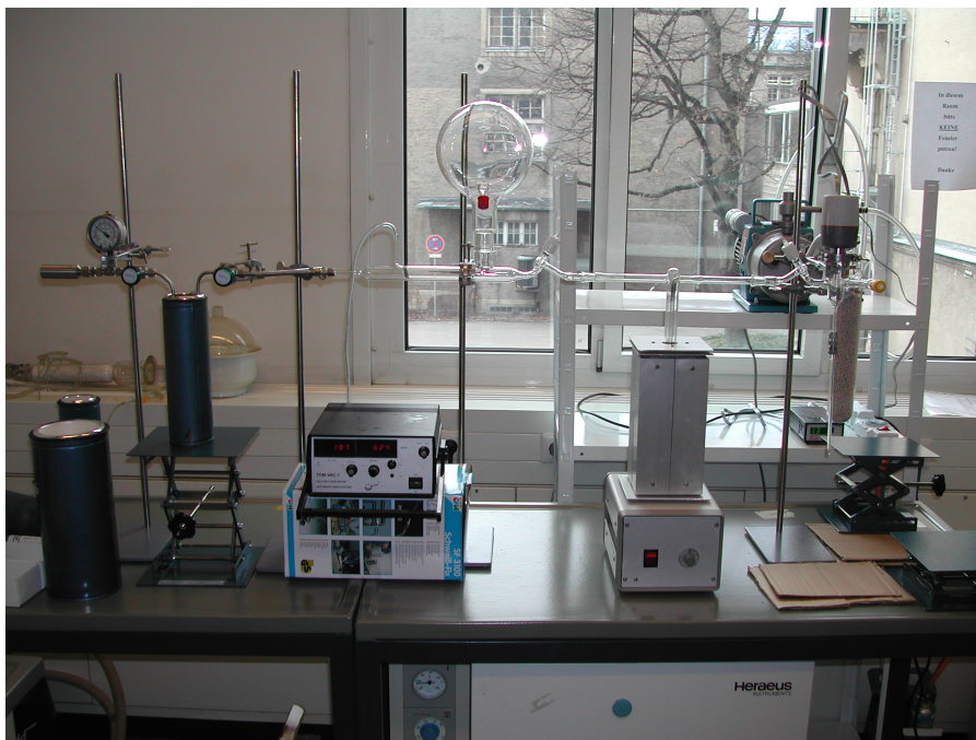
Abbildung 32: Photo der CO_2 -Linie mit Probengasflasche (links), Ofen zur O_2 -Konvertierung (Mitte rechts) und Drehschieberpumpe (hinten rechts) zur Evakuierung der Anlage.
