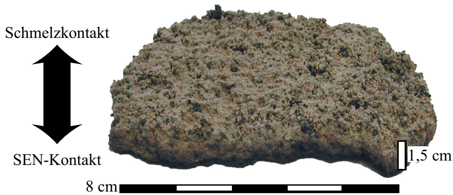
Abbildung 38: Dargestellt ist die SEN-Unterseiten-Ablagerung vom 24.10.06, Strang 4, Stahlwerk B. Ein Gradient im \delta^{18}\text{O} wurde auch bei den Cloggingproben (Ablagerungen innerhalb des Tauchrohres) vom 24.10.2006 beobachtet. Hier ist die Isotopie von Clogging, das Kontakt zur Schmelze hatte (= später abgelagerte Partikel), mit einem \delta^{18}\text{O} von +6,6‰ (Strang 3) bzw. +7,5‰ (Strang 4) ebenfalls niedriger als die des Coggings mit einem \delta^{18}\text{O} von +7,5‰ (Strang 3) bzw. +10,4‰ (Strang 4), das Kontakt zum FF-Material hatte (= früher abgelagerte Partikel).
