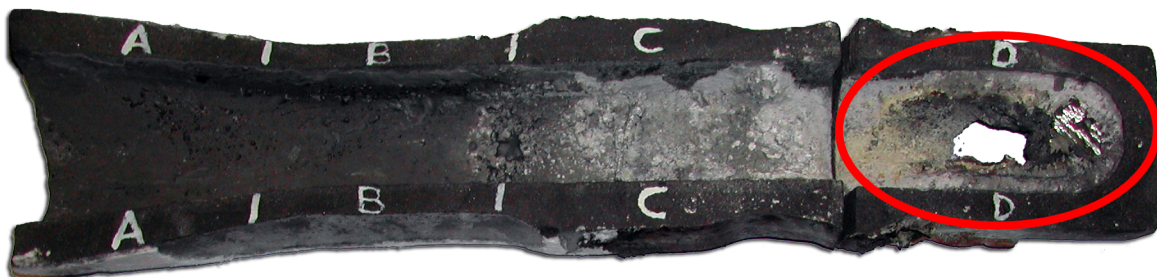
Abbildung 29: Photo von Tauchrohr 2 mit Clogging. Der rote Kreis zeigt den Bereich der Probenahme (05.09.05, Strang 2, Stahlwerk A). Das Tauchrohr hat eine Länge von rd. einem Meter und einen Innendurchmesser von rd. 9 cm im Bereich D.
