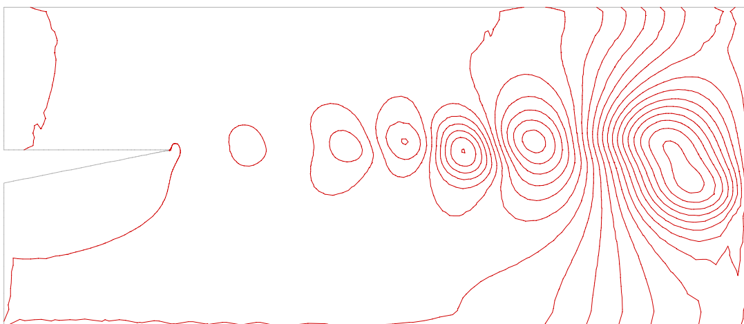
Abbildung 3.14: Isolinien des Drucks im Sättigungszustand
