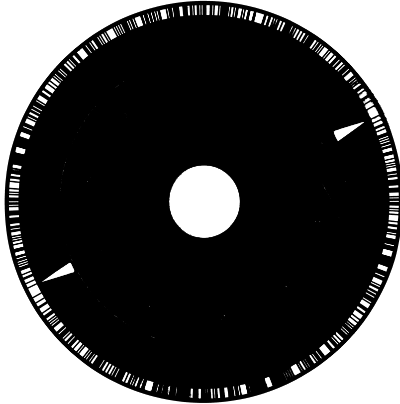
Abbildung 3.7: Chopperscheibe mit der pseudo-random-Sequenz zweimal am äußeren Rand, sowie zwei v-förmigen Schlitzten für die Erzeugung von Einzelpulsen.
