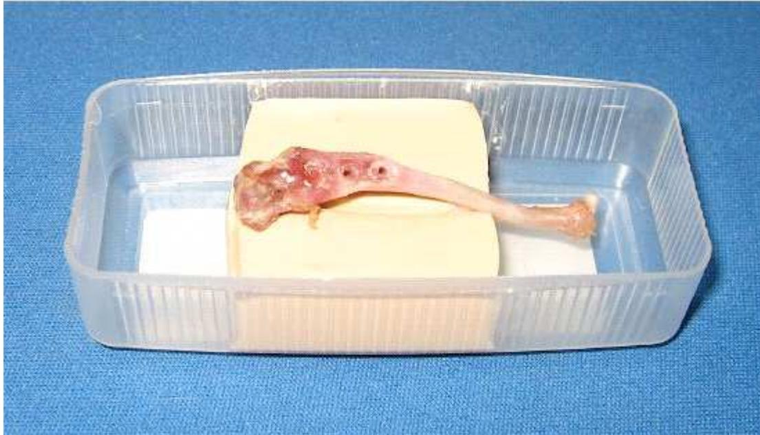
**Abb.2: Lagerung der Tibia im Hartgipsbett zur biomechanischen Prüfung**
