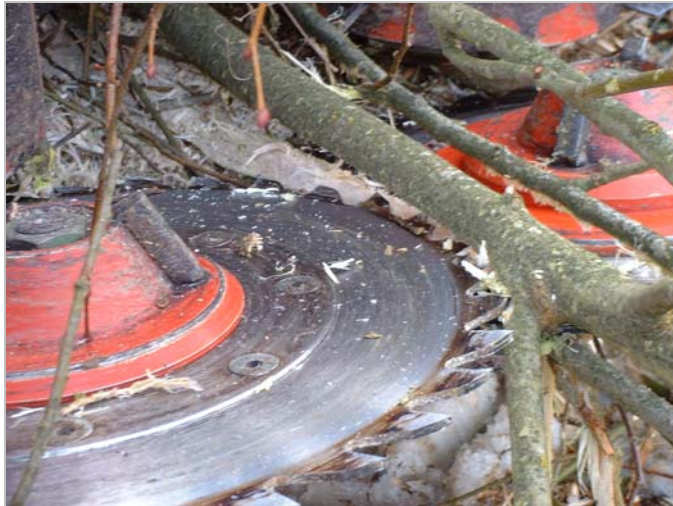
Abb. 49: Durch zu tiefe Förderung der Zuführwalzen hervorgerufene Auftrennung von Trieben längs zur Triebachse
