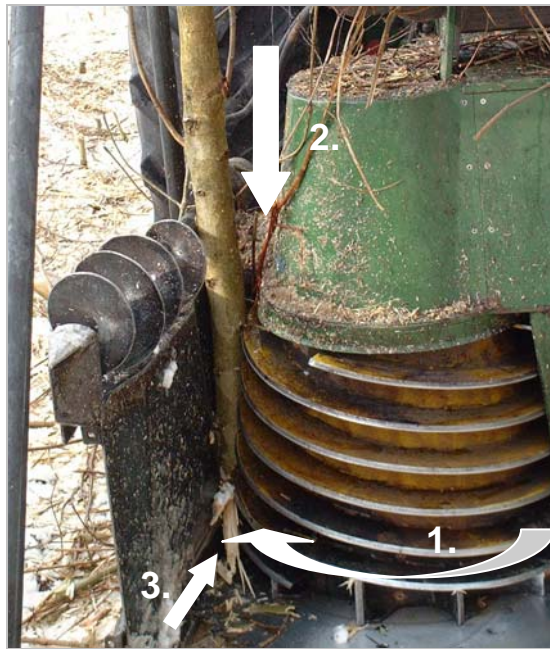
Abb. 27: Ideal geklemmter Trieb im Häckselspalt der Tritucap bei der Zerkleinerung; 1. tangentialer Transport zum Häckselspalt; 2. rotoraxialer Einzug zur Zerkleinerung; 3. Einzug der Triebachse annähernd parallel zum Pfeil bei waagerechtem Einzug der Zerkleinerung
