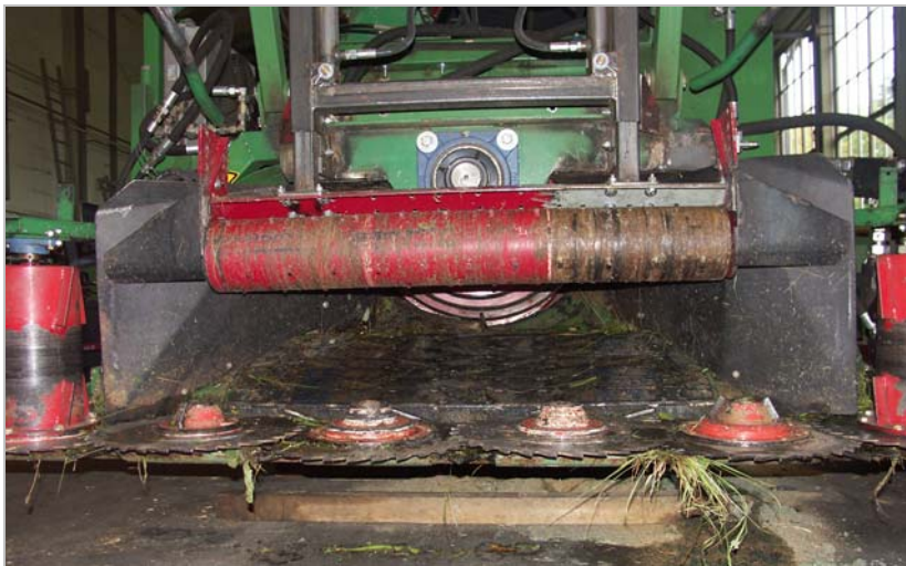
Abb. 64: Gehölmähähcksler 06 nach Austausch der Förderschnecken gegen glatte Seitenwände zur Materialkonzentration zum Häckselaggregat
