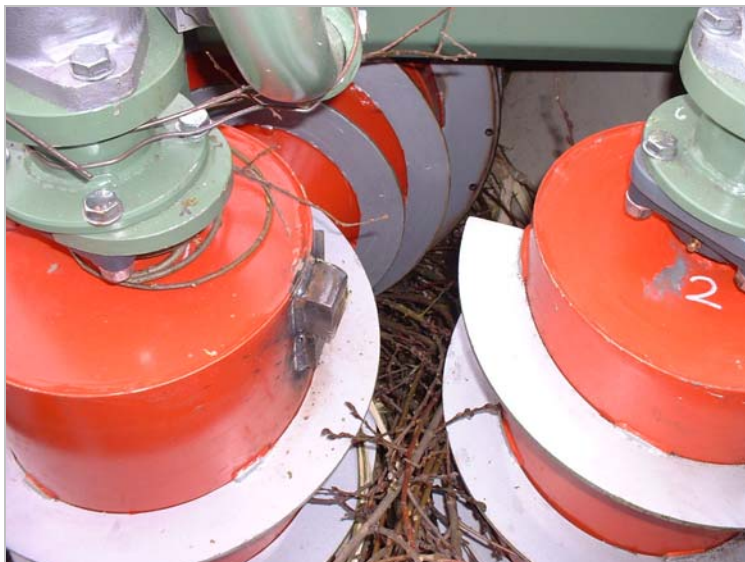
Abb. 42: Blick in die rechte Häcksel Einheit des Gehölzmähhäckslers 05 zwischen dem Zuführwalzenpaar hindurch
