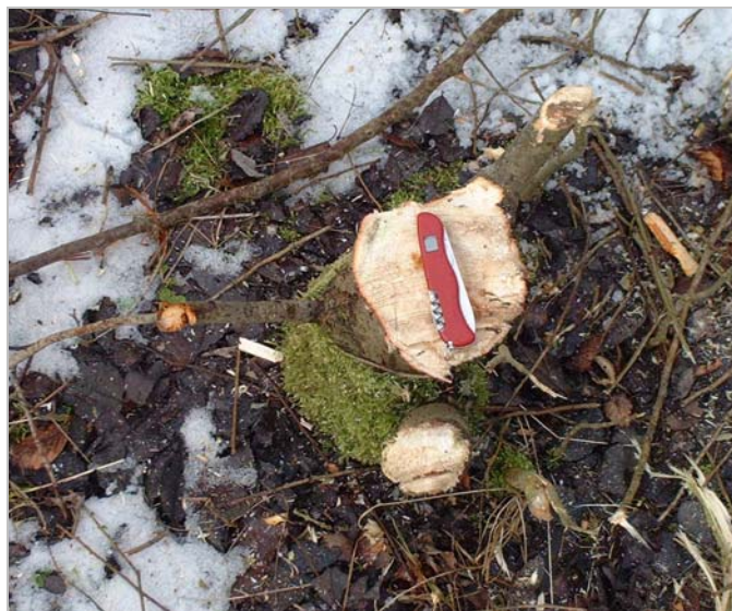
Abb. 45: Schnittfläche eines mit dem Sägeblattbalken des Gehölmähhäckslers 05 durchtrennten Weidentriebs
