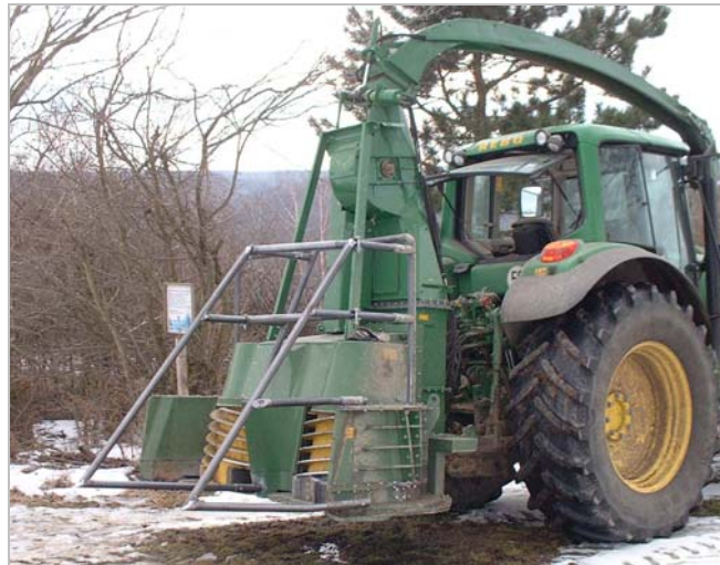
Abb. 26: Spitzbügel an Tritucap mit Überladeeinrichtung.
