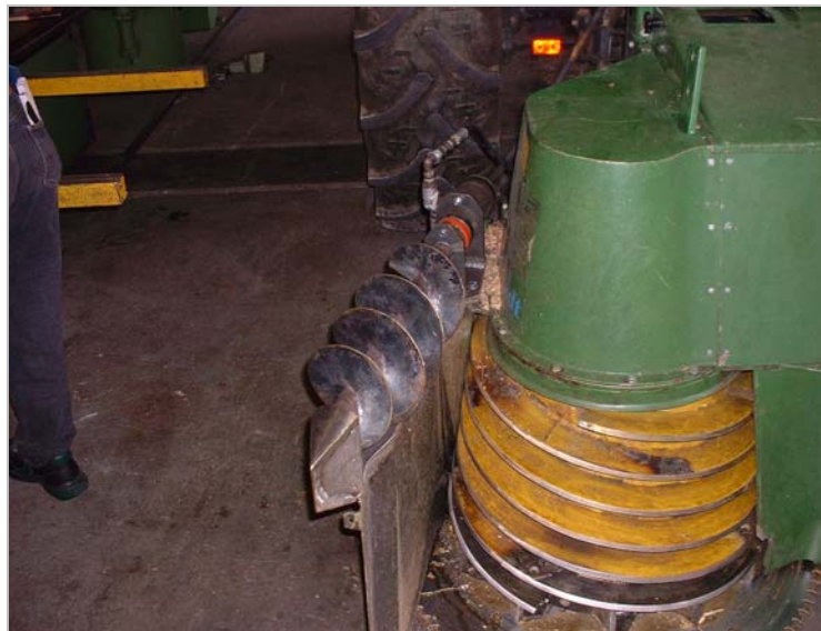
Abb. 35: Auf Seitenwand der Tritucap installierte Förderschnecke (hydrostatisch angetrieben)
