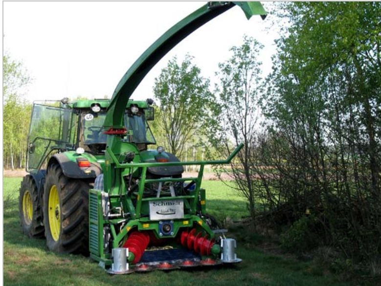
Abb. 55: Gehölmähhäcksler 06 im Frühjahr 2007 nach der Fertigstellung
