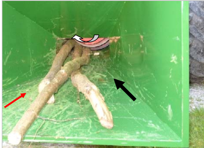
Abb. 53: Blick in den Zuführtrichter eines manuell beschickbaren Schneckenhäckslers bei der Zerkleinerung; weißer Pfeil: Drehrichtung der Häckselschnecke; roter Pfeil: behinderte Zuführrichtung durch Gehölztriebe während der Verarbeitung; schwarzer Pfeil: weitere Zuführung möglich
