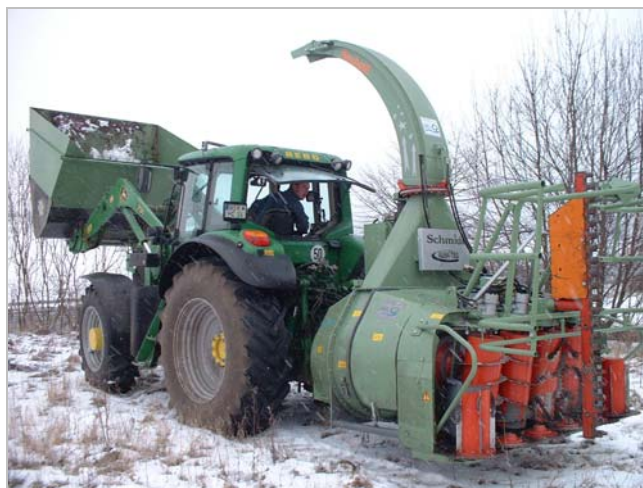
Abb. 44: Ansicht des Gesamtmaschinensystems zur vollmechanisierten Entbuschung mit dem Gehölmähmäcksler 05
