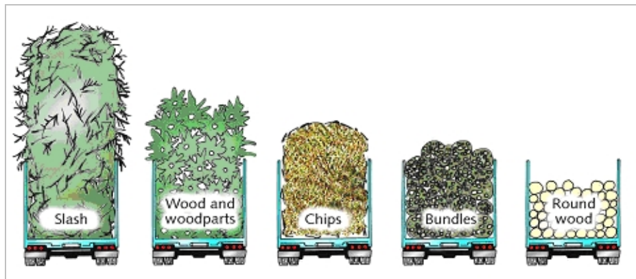
Abb. 21: Transportvolumen der gleichen Menge Holz in Abhängigkeit von der Beschaffenheit (Quelle: Timperi; A.; Finnland)
