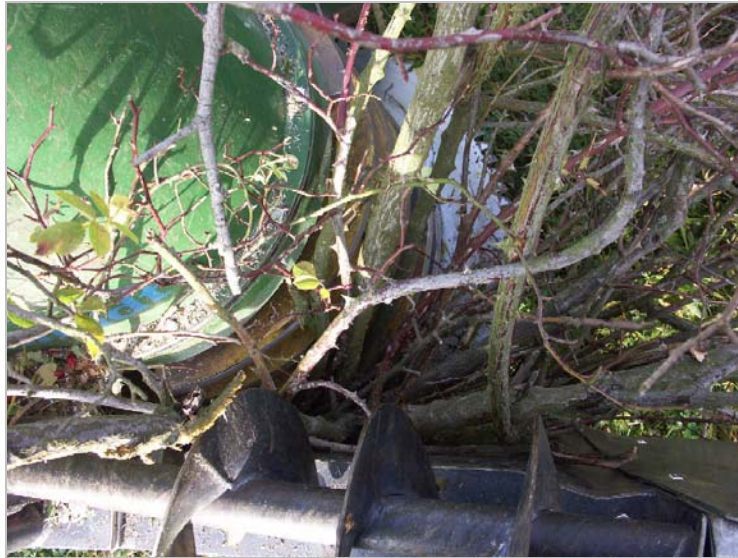
Abb. 37: Blockade des Häckselrotors mit verlängerten Windungen durch den gleichzeitigen Einzug einer mehrtriebigen Hundsrose (Blick von oben in den Häckselspalt)
