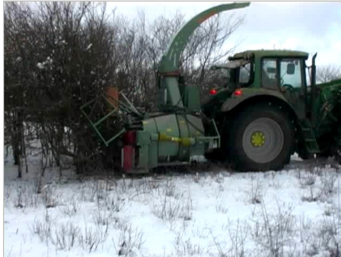
Abb. 46: Hohe Bestandesdichte und vermehrt dickere Weißdornbüsche behindern waagerechte Ausrichtung der Gehölze mit dem Gehölmähhäcksler 05
