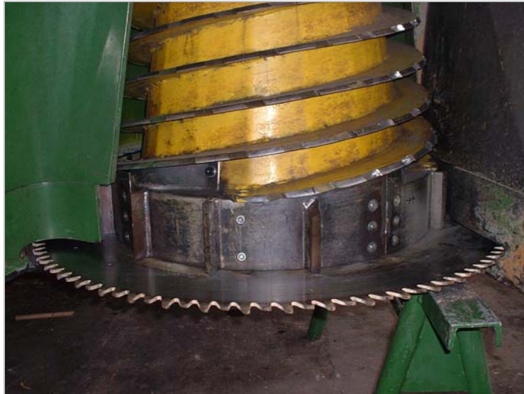
Abb. 33: Linker Häckselrotor der modifizierten Tritu-cap 3 mit Auswerfermantel
