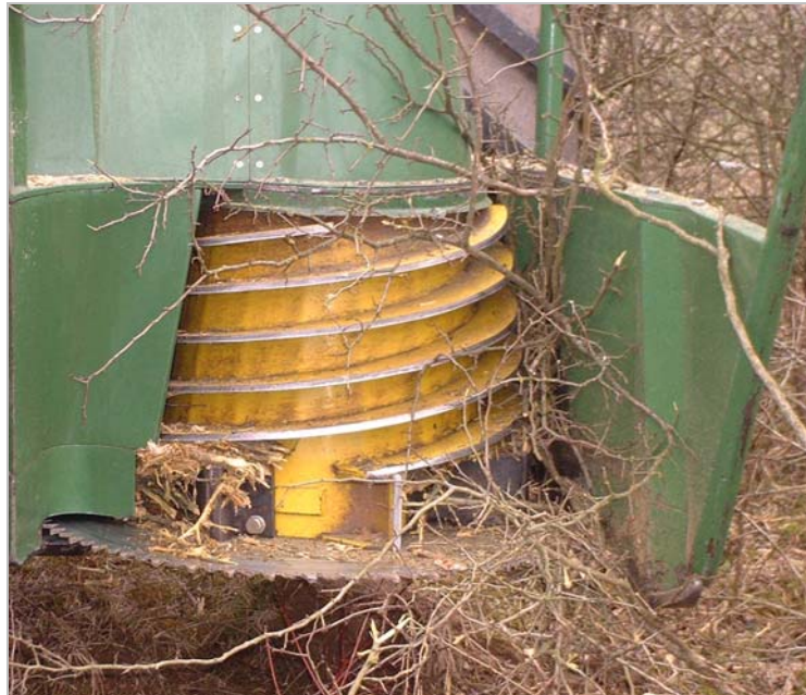
Abb. 30: Verstopfung des Häckselspalt es durch verstärkt waagrecht eingezogenes Material dünneren Durchmessers
