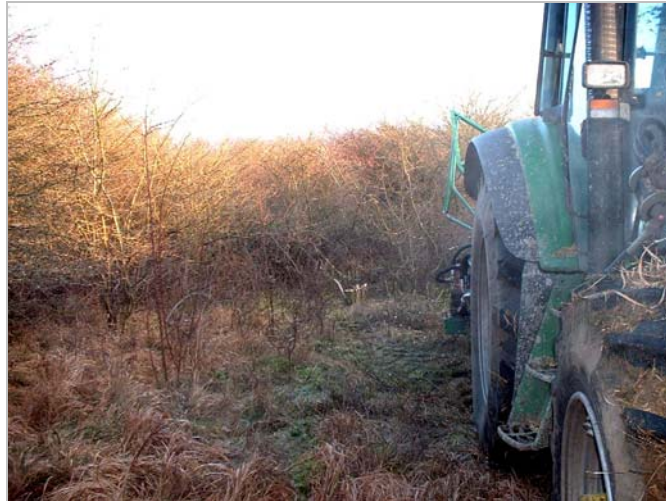
Abb. 63: Abbruch der vollmechanisierten Entbuschung mit dem Gehölmähhäcksler 06 durch eine zu hohe Bestandesdichte in buschartiger Vegetation mittleren Wurzelhalsdurchmessers (6-8 cm WHD)
