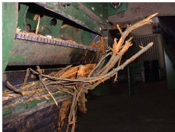
Abb. 31: Geöffnete Wartungsklappe am ersten Beschleuniger der Tritucap nach Blockade durch dünnes und überlanges Gehölzmaterial nach waagrechttem Triebeinzug durch die Häckselrotoren
