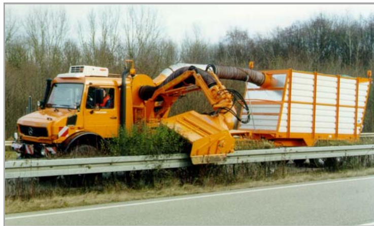
Abb. 22: MULAG Heckenschneidkopf HSK 1200 bei der Autobahn-Mittelstreifenpflege mit gleichzeitiger Absaugung des Häckselmaterials (MULAG FAHRZEUGWERK HEINZ WÖSSNER, 2006)
