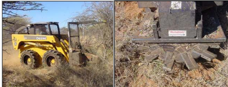
Abb. 4: Kompaktlader beim Fällen von Büschen in Namibia (links) mit robust ausgeführter Rotorsäge (rechts) (LEINONEN, 2007)
