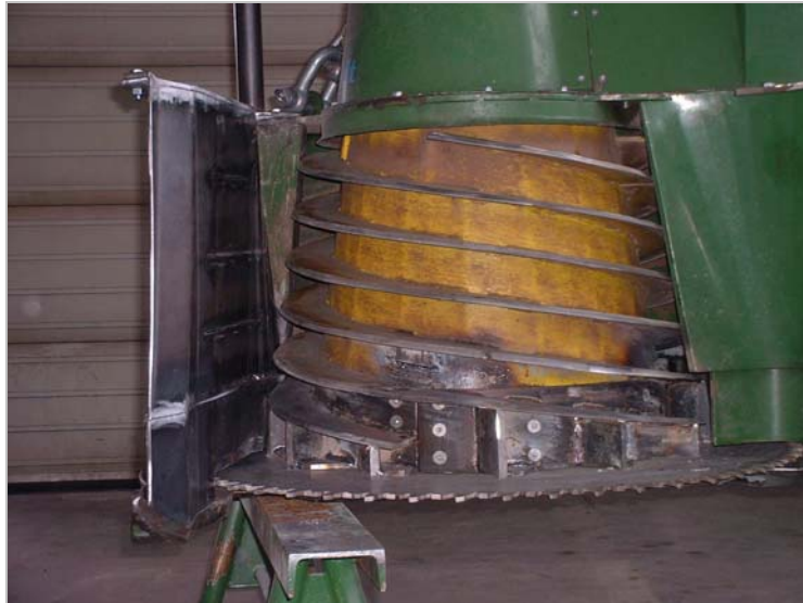
Abb. 34: Umbau eines Häckselrotors an der Tritucap: Verlängerung der Schneidwindungen und Integration von drei Auswerfern je Schneidwindung ohne Überstand über die Schneide; Anpassung der Seitenwand und des Häckselspaltes.
