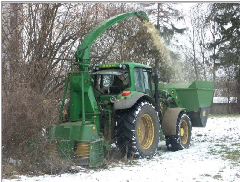
Abb. 25: Modifizierte Tritucap mit Überladeeinrichtung und Frontladercontainer bei vollmechanisierter Entbuschung
