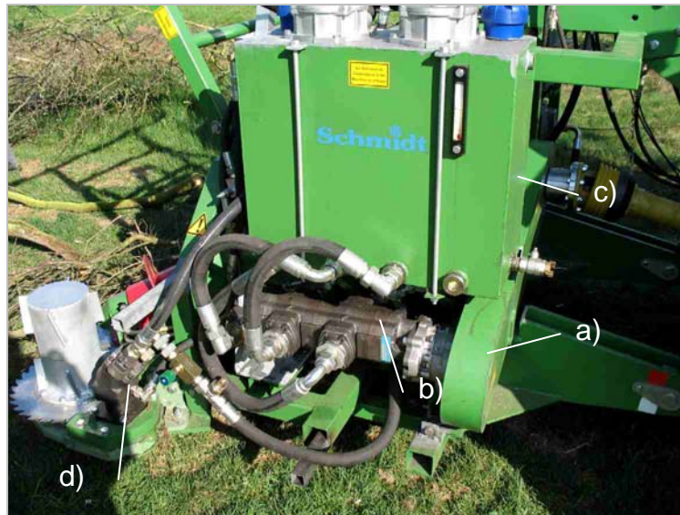
Abb. 60: Hydraulische Eigenversorgung des Gehölmähähäckslers 06 mit a) Keilriemenantrieb; b) Dreifachpumpe; c) Öltank (100 Liter) mit Ölfiltern; d) Ölmotor des Sägeblattantriebs
