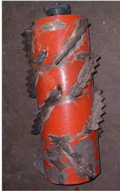
Abb. 50: Mit gezahnten Förderelementen ausgestatteter Förderzylinder des Gehölmähähäckslers 05
