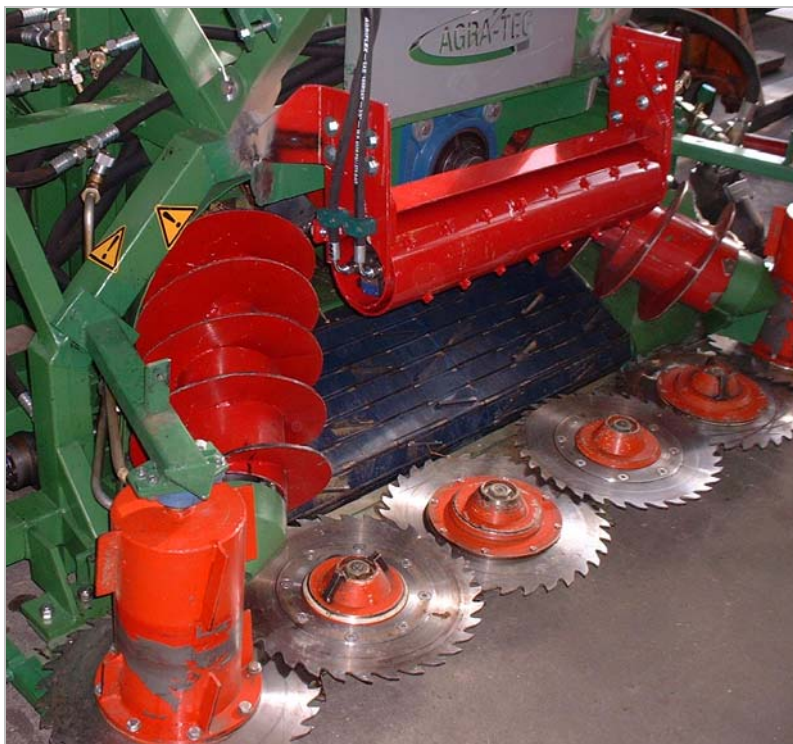
Abb. 58: Blick auf die Schneid- und Zuführkomponenten des Gehölzmähhäckslers 06. Über dem Übergang von Sägeblattbalken und Scharnierbandboden (blau) ist eine hydraulisch angetriebene Förderwalze installiert.
