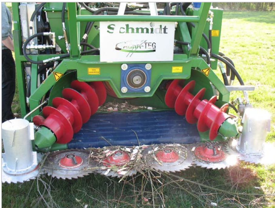
Abb. 57: Blick in den Arbeitsbereich des Gehölzmähhäckslers 06 mit Zuführschnecken (rot), Scharnierbandboden (blau) und Förderzylindern (silber)
