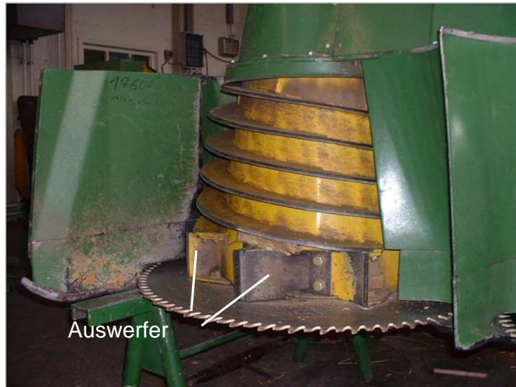
Abb. 32: Rechter Häckselrotor der modifizierten Tritucap 3 mit insgesamt acht Auswerfern pro Häckselrotor
