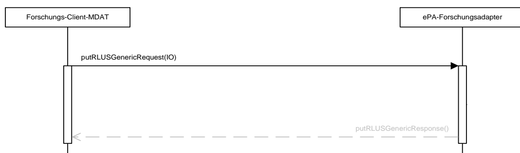
Abbildung 31: Bereitstellen eines Informationsobjektes durch den Forschungs-Client-MDAT an den ePA-Forschungsadapter
