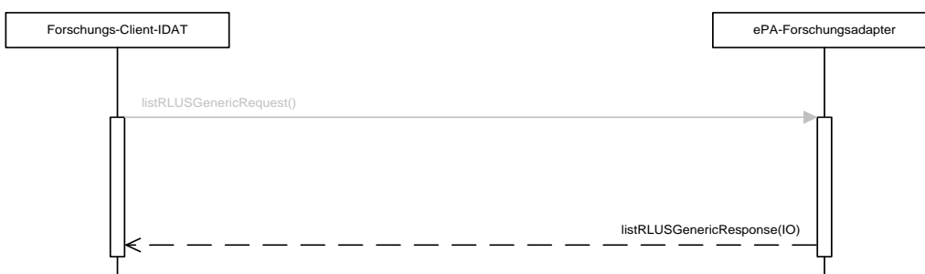
Abbildung 29: Abrufen eines Informationsobjektes durch den Forschungs-Client-IDAT vom ePA-Forschungsadapter
