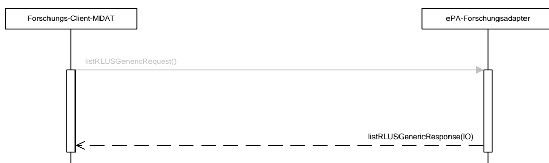
Abbildung 30: Abrufen eines Informationsobjektes durch den Forschungs-Client-MDAT vom ePA-Forschungsadapter
