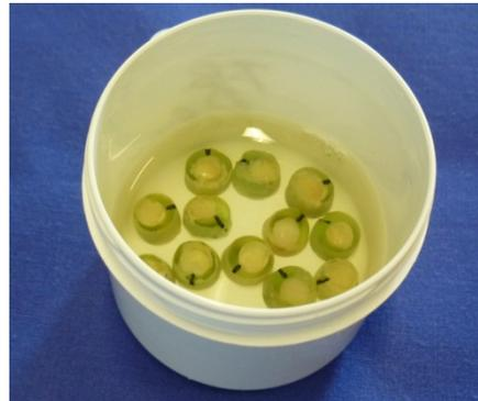
Abb.4.10 Schraubdeckeldose, verschlossen und ohne Deckel mit darin gelagerten Prüfkörpern
