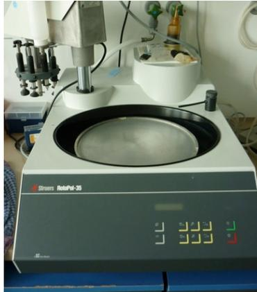
Abb.4.4 RotoPol-35 Poliermaschine
