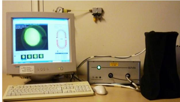
Abb.4.9 QLF- Apparatur mit PC, angeschlossenem QLF- Auslesegerät, Kamera und Lichtquelle (Kamera und Lichtquelle werden von dem Verdunkelungstuch bedeckt)
