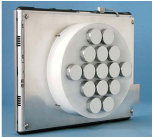
Abbildung 20: Tablet-PC in Ansicht von unten auf das Elektroden-Array (Abbildung zur Verfügung gestellt von Oehler 2011).
