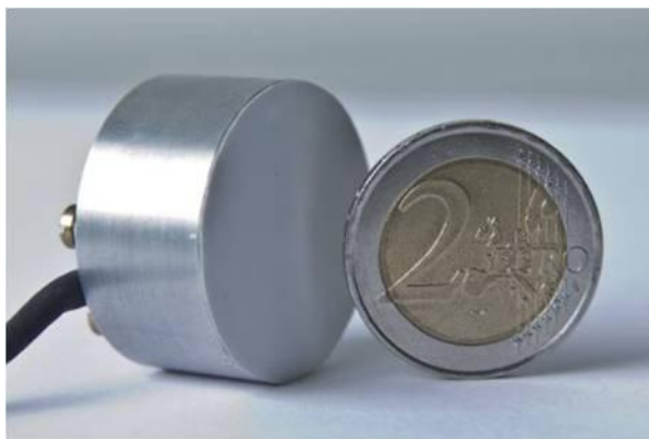
Abbildung 16: Einzelne kapazitive Elektrode im Größenvergleich mit einem 2-Euro-Stück (Abbildung zur Verfügung gestellt von Oehler 2011).
