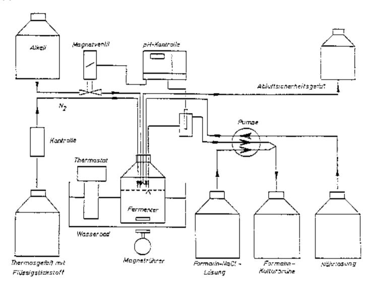
Abbildung 2.3. Schemazeichnung eines Göttinger Bioreaktors für die Herstellung von Clostridium-Toxoid-Vakzine.
