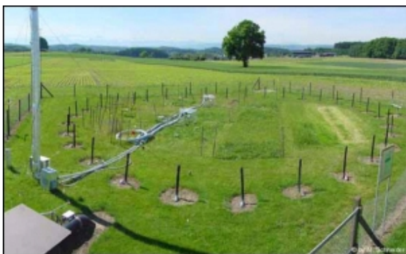
ABBILDUNG 8.3: Aufbau eines FACE-Experiments (www.bnl.gov)
