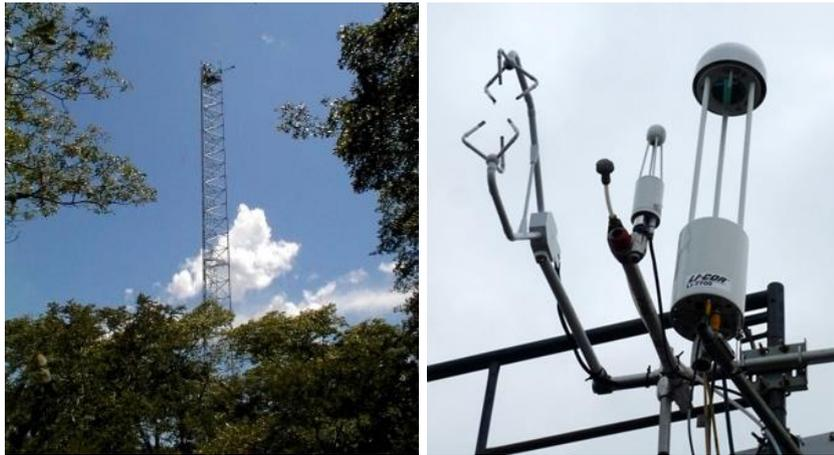
**Abbildung 4.4: Messturm der Station Mongu (links) und die Anordnung der Messgeräte an der Spitze des Messturms (rechts), mit Ultraschallanemometer (rechtes Bild links), Infrarot Gasanalysator für CO<sub>2</sub> und H<sub>2</sub>O (rechtes Bild Mitte) und Gasanalysator für CH<sub>4</sub> (rechtes Bild rechts). (Bilder: fluxnet.ornl.gov und licor.com)**
