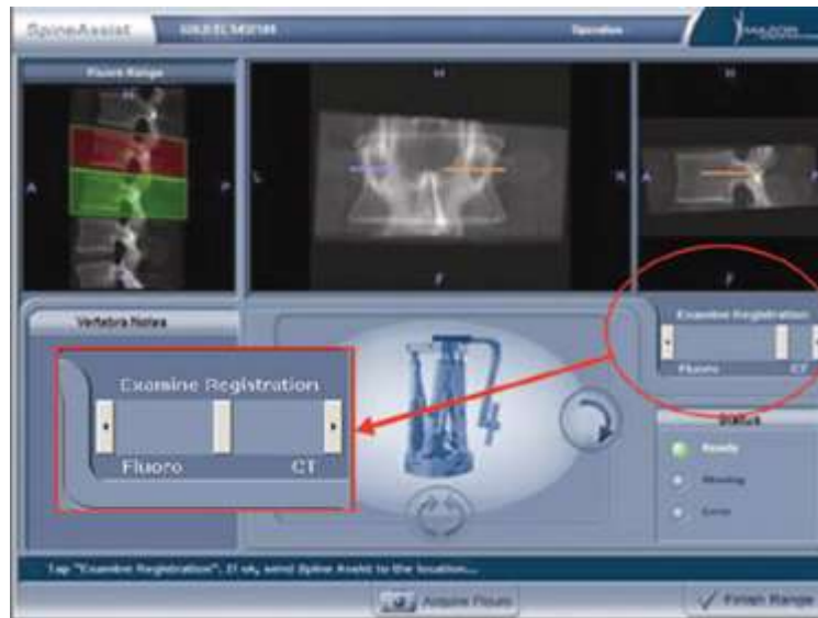
Abbildung 15: Überprüfung des Matchings: unter Verwendung einer Scrollfunktion wird der exakte Abgleich von intraoperativen Röntgen-Bildern mit präoperativen CT-Datensätzen durchgeführt (Lieberman et al. 2006, S. 646)
