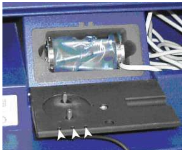
Abbildung 12: Zeigt die Bohrschablone zur Überprüfung der Systemgenauigkeit des SpineAssist R Roboters (Lieberman et al. 2006, S. 644)
