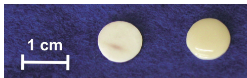
Abb. 24: Fertig gesinterte und verblendete Scheiben der TZP-Keramik Cercon base - auf der rechten Seite ist die Verblendkeramik zu sehen.
