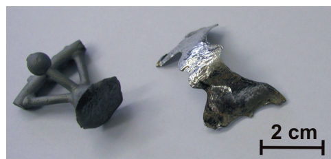
Abb. 26: Gusskanäle von Wiron 99 und fertiges Prothesengerüst Remanium GM 800+ .
