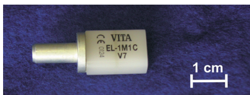
Abb. 20: CAD/CAM-Block der Feldspat-Keramik Vitablocs - Esthetic Line .
