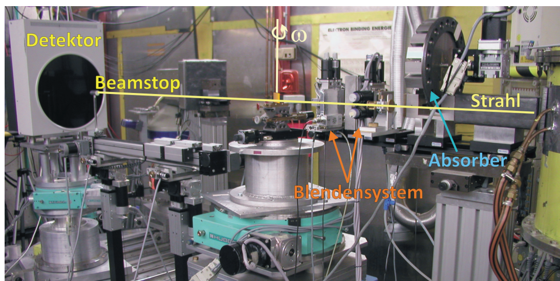
Abb. 32: Synchrotron-Beamline BW5 (HASYLAB, Hamburg). Die gewünschte Wellenlänge, z.B. 0,123\text{\AA} ( \approx 100\text{ kV} ) wird durch einen Monochromator, meist imperfekter SiGe(111)-Kristall, aus dem Synchrotron-Spektrum gefiltert und über Kollimatoren, evtl. Absorber und Blendensystem auf die Probe fokussiert, an der die Strahlung an den Kristallflächen des Probenmaterials im Bragg-Winkel gebeugt wird. Die transmittierte, gebeugte Strahlung wird schließlich mit einem 2d-Detektor erfasst, wobei der Primärstrahl zum Schutz des Detektors durch einen Beamstop absorbiert (hier: mar345 Image Plate Detector , der 2011 durch den schnelleren PerkinElmer-Detektor XRD1621 flat panel detector abgelöst wurde). Für die Texturmessungen wurden die Proben um die Drehachse \omega gedreht.
