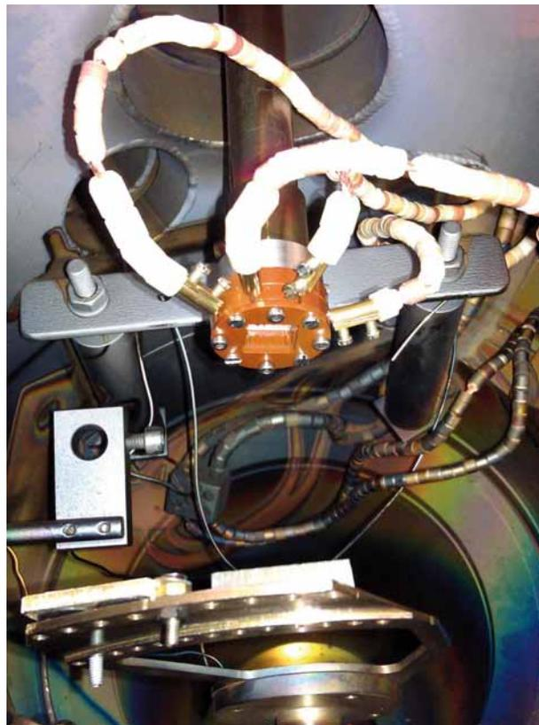
**Abbildung 3.3:** Kammeransicht der *in-situ*-Widerstandsmessung. Zwischen präparierter Probe im Widerstandshalter und Targethalter (im Bildvordergrund) ist ein Target-Substrat-Abstand von 6 cm eingestellt worden. Die elektrischen Zuführungen wurden an einem Keithley2000 außerhalb der UHV-Kammer angeschlossen.
