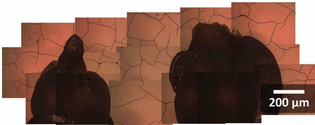
**Abbildung 8.10:** Rissbildung der Polymerschicht bei Lösungsmittelabsorption. Die Polymerketten können nicht schnell genug relaxieren während die Lösungsmittelmoleküle im Polymer diffundieren, und so bauen sich große Spannungen in der Polymerschicht auf.
