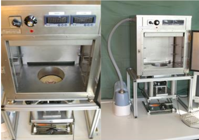
Abb. 6 Kompletter Versuchsaufbau; im linken Teil des Bildes ist die Kunststoffschale mit Zahnkranz am Boden des Thermoschranks zu erkennen. In der rechten Bildhälfte ist der komplette Versuchsaufbau in Frontalansicht gezeigt. Unter dem Thermoschrank wurde der Hubtisch mit dem kompletten Messsystem platziert (aus Hahn 2009, S. 9).
