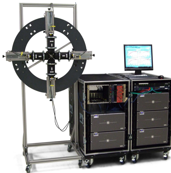
Abbildung 3.4: Aufbau der digitalen PAC-Apparatur in seiner ursprünglichen Form nach Referenz [77]. Mittlerweile wurde die Anlage von vier LYSO- auf sechs \text{LaBr}_3(\text{Ce}) -Detektoren umgebaut. Durch den Austausch der vier Messrechner durch sechs flache PCs lässt sich die komplette Elektronik in einem Rack unterbringen. (Copyright ©2010, AIP Publishing LLC)
