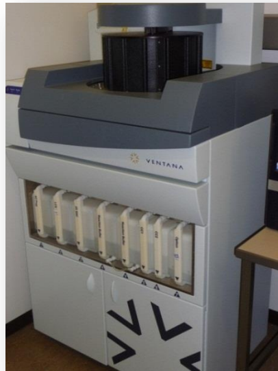
Abbildung 8: Färbeautomat Benchmark XT der Firma Ventana
