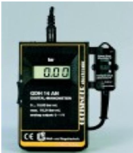
Abbildung 8: GDH 14 AN Digital-Manometer (Fa. Greisinger) zur Berstungsdruckmessung.
