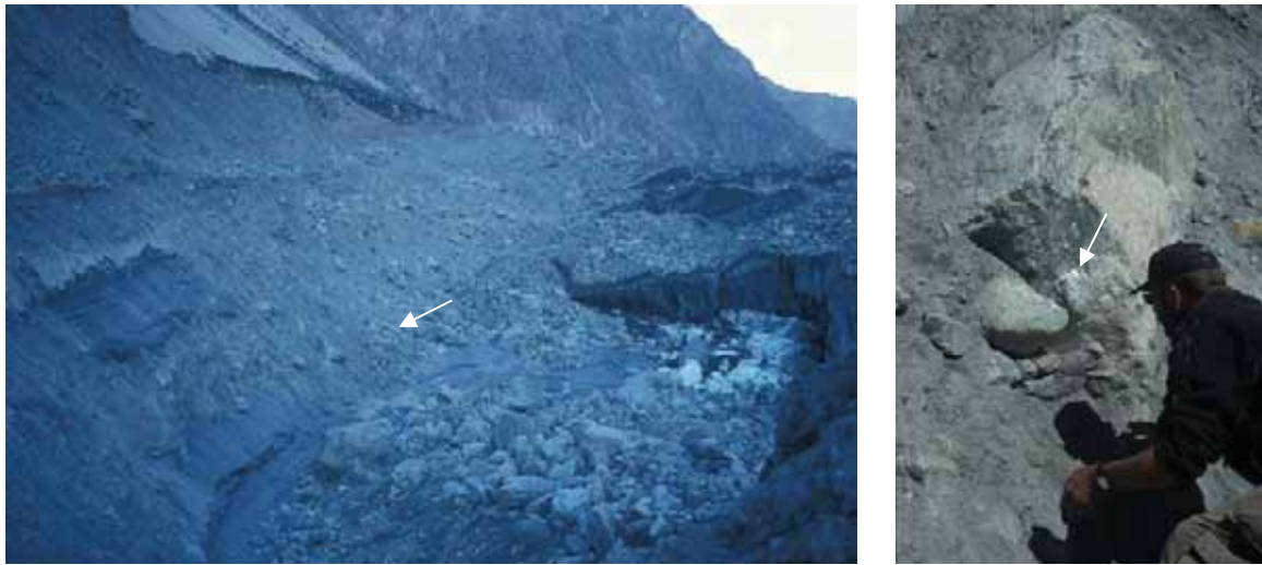
Photo 4.1.1.28 & 29: Messlokalität im linken Eisrandtal bei Yashpirt am südexponierten Ufermoräneninnenhang des Batura-Gletschers (links) und Aufnahme des eingegrabenen Temperaturmessgerätes mit dem mit Silikon befestigten Temperaturfühler auf der Gesteinsoberfläche (✓).
