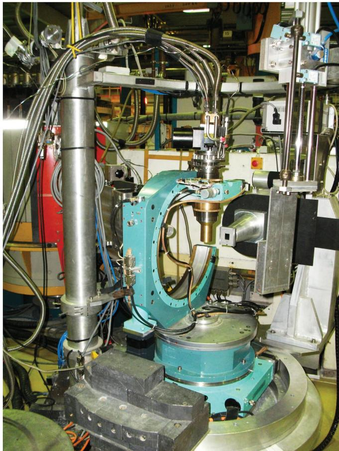
**Abbildung 3.3:** Darstellung des Einkristalldiffraktometers D10. Oberhalb der Eulerwiege befindet sich eine halbkreisförmige Metallhalterung, welche die Kippung des  $\chi$ -Kreises stark einschränkt.
