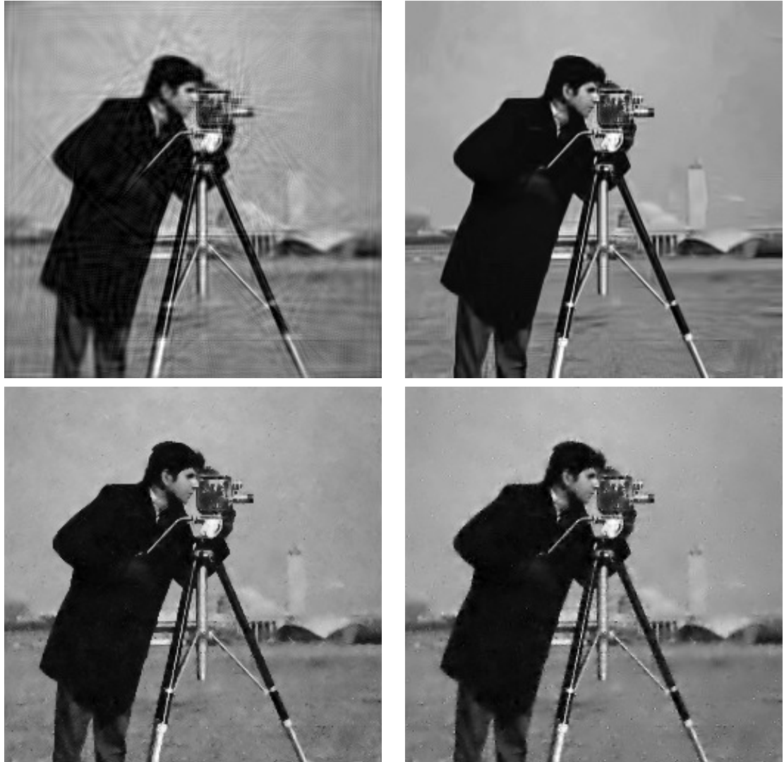
Abbildung 2.11: Entzörung des „Cameraman“-Bildes ( \sigma = 0.1 ) mittels Shearlets (oben links), BM3D (oben rechts), Algorithmus 2.63 mit adaptiv deterministischer (unten links) und adaptiv zufälliger Pfadkonstruktion (unten rechts).
