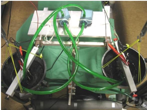
Abb. 2-12: Pumpsystem mit Wasserbehältern. Die beiden Pumpen (oben) befördern die Flüssigkeit zwischen den beiden Behältern hin und her.
