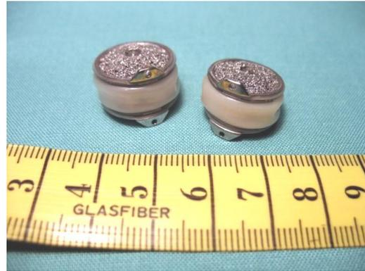
Abb. 1-17: Bryan® Cervical Disc System; Die Polyurethanhülle umschließt den Kunststoffkern und verbindet die beiden Deckplatten mit poröser Oberfläche.
