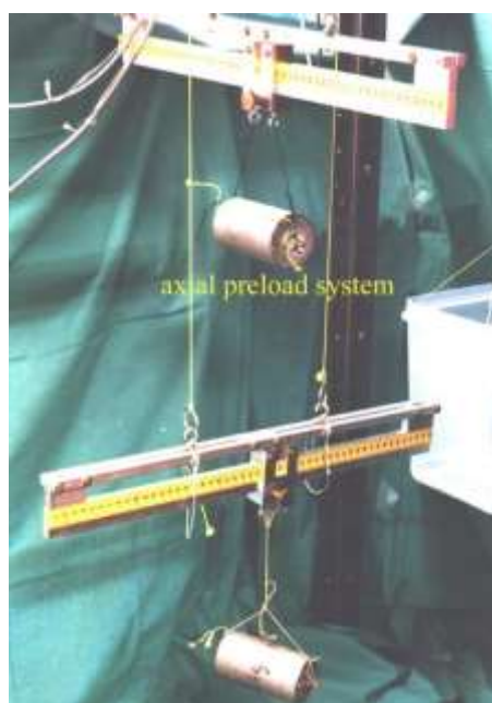
Abbildung 19: Prinzip der Anbringung der Vorlast an verschieblichen Reitern (Mansour 2001, S. 60)
