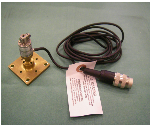
Abbildung 2.2.1: Der Nano 17 Sensor. Eine Klemmvorrichtung am oberen Ende dient der Aufnahme eines Messzahnes. Über den Metallfuß wird der Sensor reversibel an einem Positionierungstisch befestigt.
