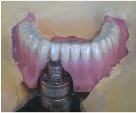
Abbildung 2.8.2: Eingliederte Schiene und das mit dem Sensor verbundene Untersuchungsmodell
