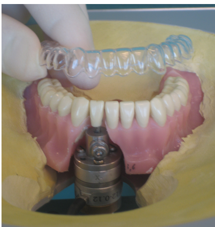
Abbildung 2.8.1: Aufsetzen einer Schiene auf das mit dem Sensor verbundene Unterkiefermodell
