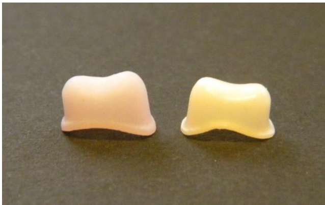
Abb. 6: Glaskeramik vor dem Sintern (links) und nach dem Sintern (rechts)
