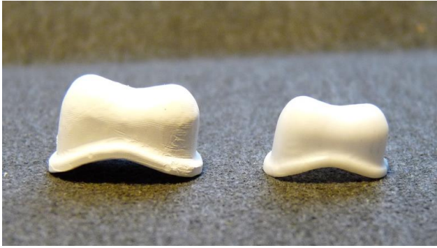
Abb. 5: Zirkoniumdioxid-Käppchen vor dem Sintern (links) und nach dem Sintern (rechts)
